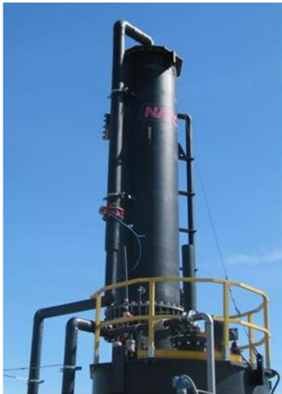
Sistema de limpieza de gases de la industria lechera (lavador de gases)
