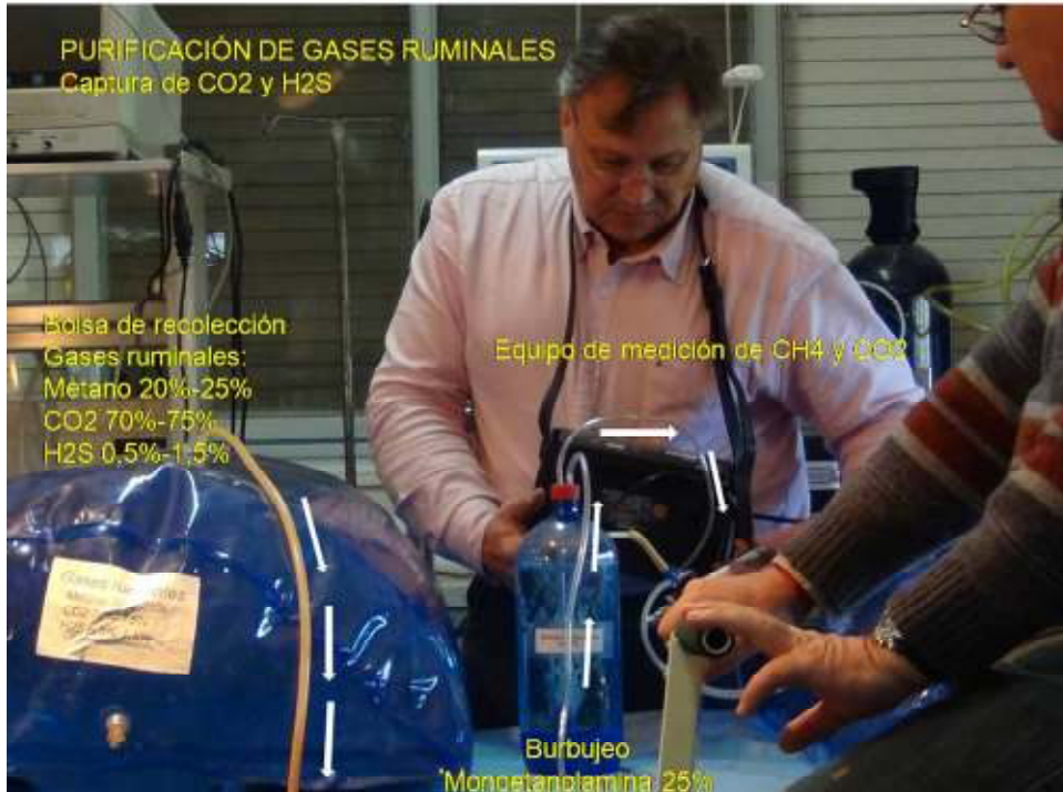
Foto 9: Purificación de gases ruminales con burbujeo en monoetanolamina al 25 %
