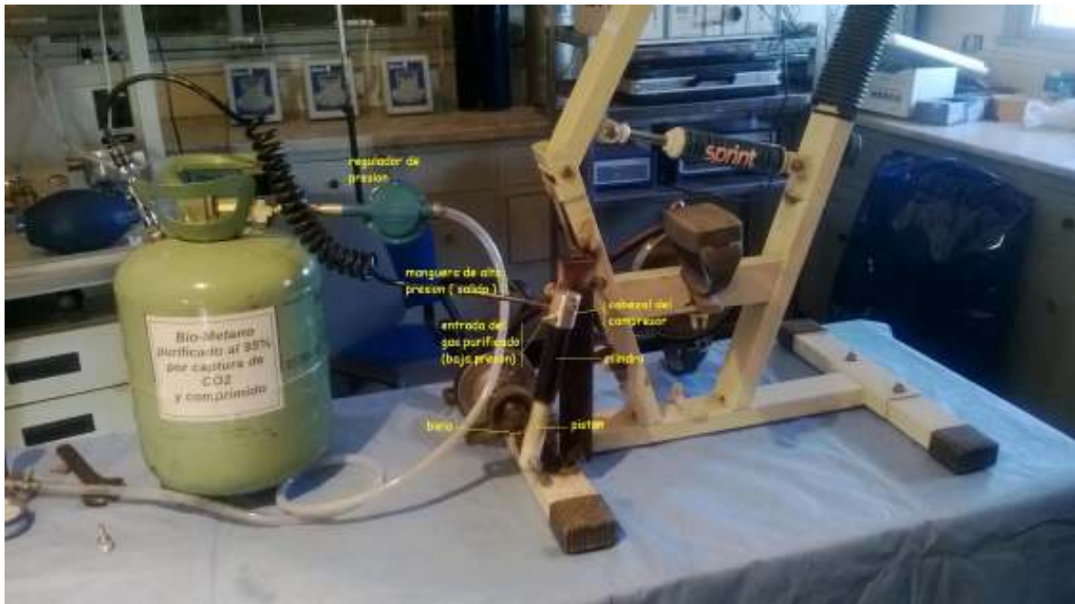
Foto 10: Bicibomba componentes
