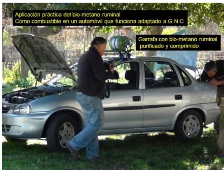
Foto 11: Fijación de la garrafa portadora de biometano en el porta equipaje del automóvil
