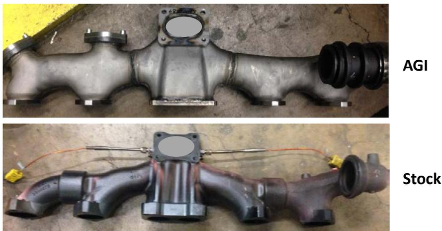
**FIGURE 23. COMPARISON OF AGI AND STOCK EXHAUST MANIFOLDS**
