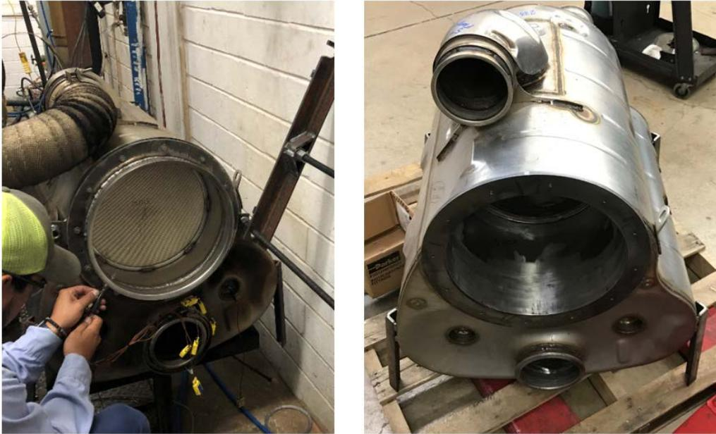
**FIGURE 20. STAGE 3 FINAL DOWNSTREAM SYSTEM SHOWING REMOVABLE ZONED-CSF MODULE**
