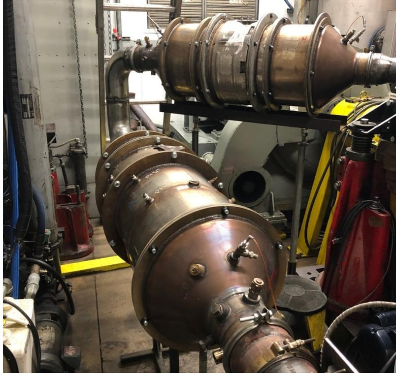
FIGURE 14. CONFIGURATION 2A COMPLETE SYSTEM DURING INSTALLATION
