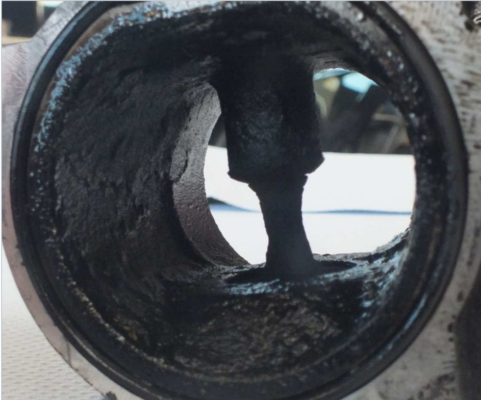
Abb. 6 ausgebautes AGR-Ventil mit Rußablagerungen (nach Zustand 6)
