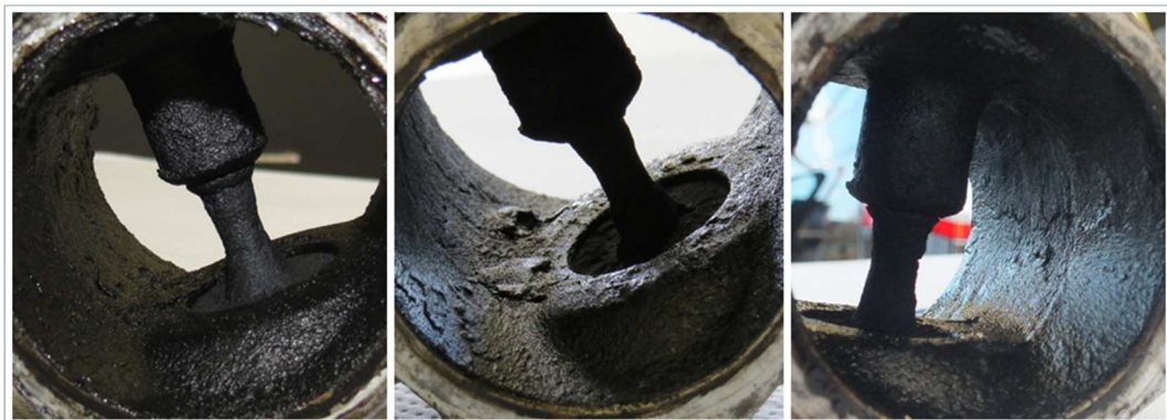
Abb. 15 AGR-Ventil im Ausgangszustand, nach Zustand 3, Endzustand (v. l. n. r.), Rückansicht
