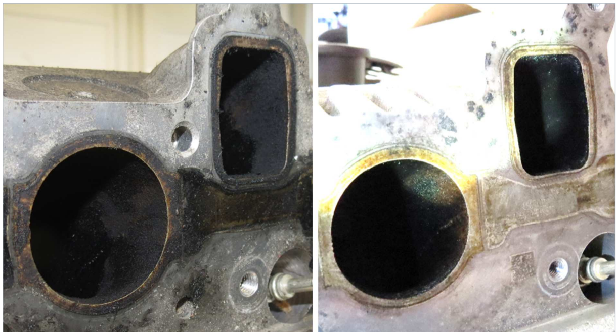
Abb. 11 Ein- und Auslasskanäle im Ausgangs- (links) und Endzustand (rechts)
