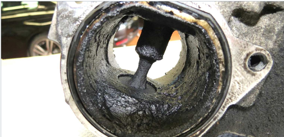
Abb. 2 AGR-Ventil mit Rußablagerungen (Ausgangszustand)
