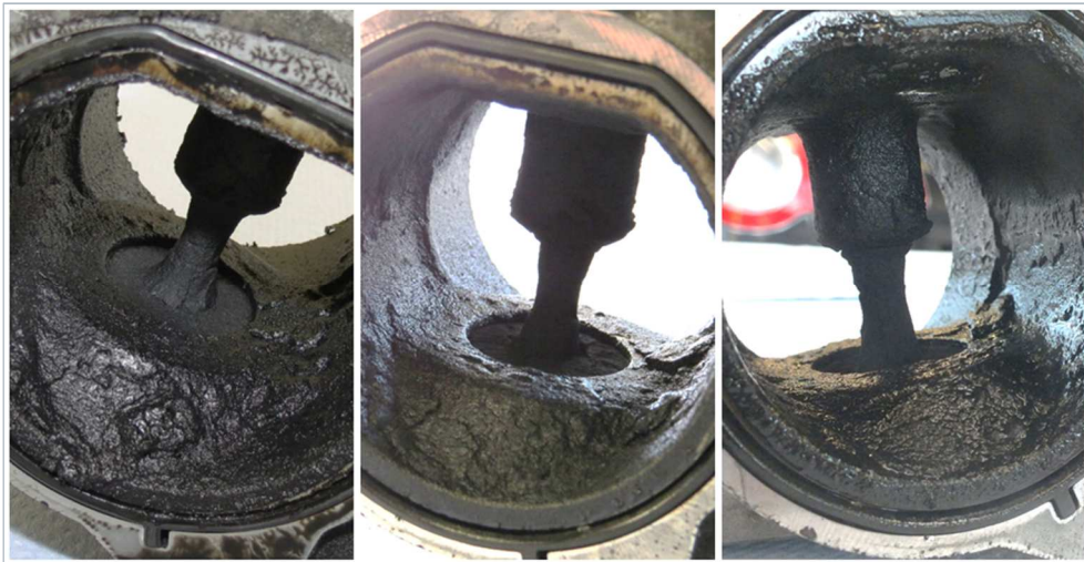
Abb. 14 AGR-Ventil im Ausgangszustand, nach Zustand 3, Endzustand (v. l. n. r.), Vorderansicht
