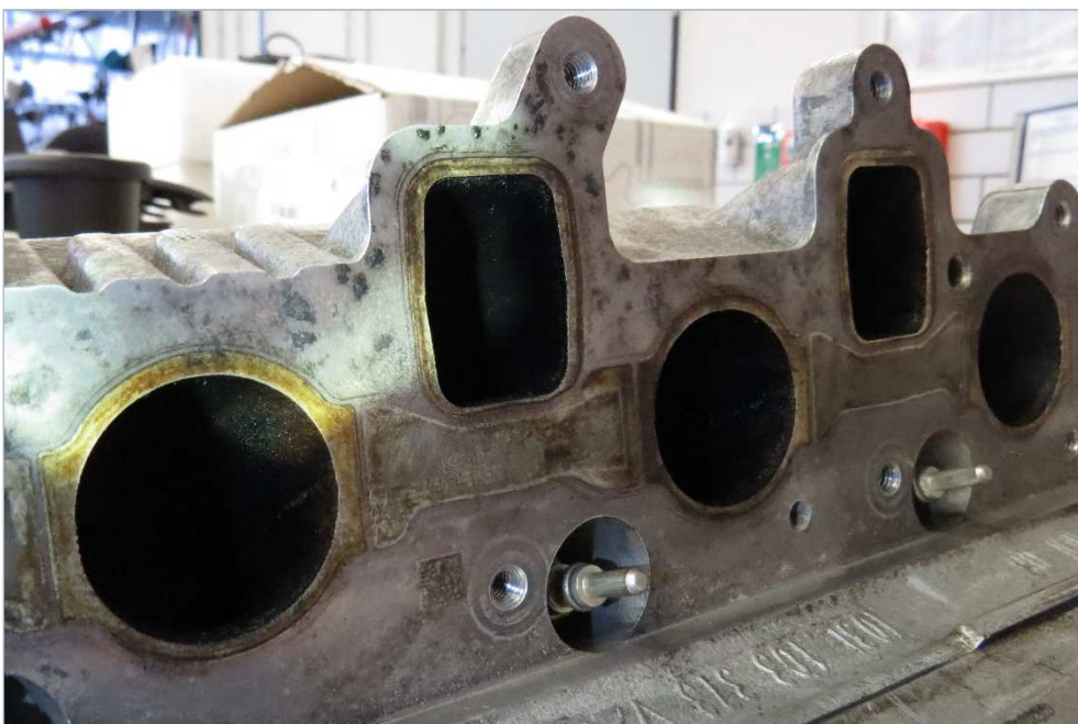
Abb. 7 Einlasskanäle des Zylinderkopfes mit Rußablagerungen (nach Zustand 6)
